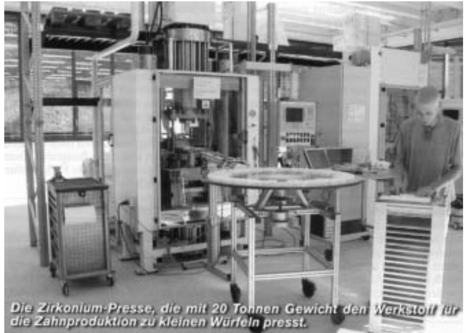
Die Zirkonlum-Pressen, die mit 20 Tonnen Gewicht den Werkstoff für die Zahnproduktion zu kleinen Würfeln presst.
